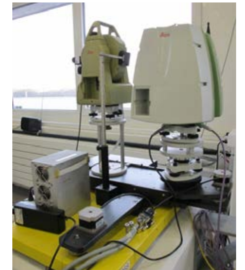
Figura 18: La Stazione di taratura del "Tilt" per il Leica ScanStation C10. Si controlla la temperatura quando si monta il sensore di inclinazione.
