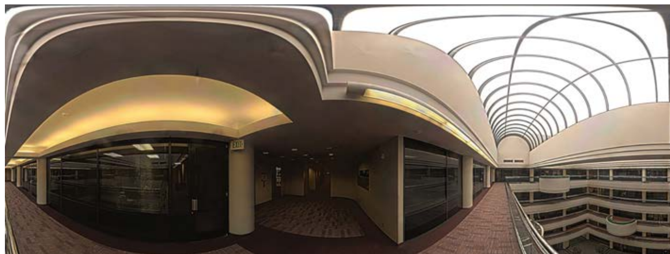
Figura 21: vista a mappa di riflettanza dell'atrio dell'ufficio di Leica Geosystems a San Ramon in California. Questa immagine è una proiezione sferica di un panorama assemblato da 260 immagini HDR scattate con una ScanStation P40.
