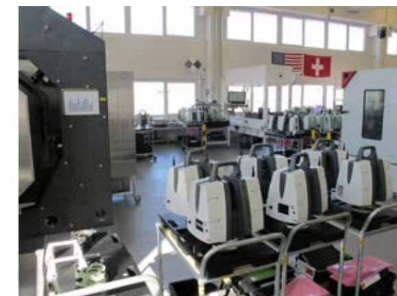
Figura 10: Un set di scanner laser P40 in attesa di calibrazione sul piano di produzione a Widnau, Svizzera.
