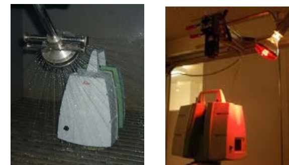
Figura 23: Un mosaico di eventi di prova per gli scanner della serie C e P. C'è qualcosa di simile ad un soffione regolatore, tra le altre cose.
