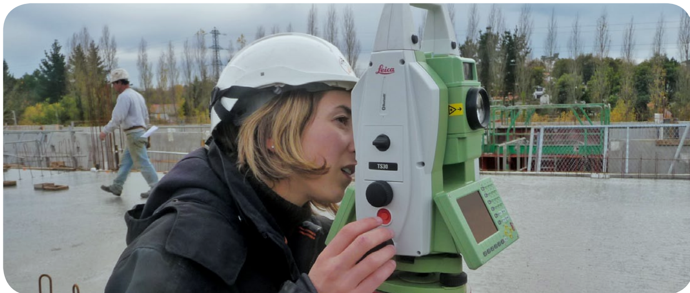
■ Implantation précise des façades rideaux : l'ingénieur-géomètre Julie Deléglise avec la Leica TS30.
