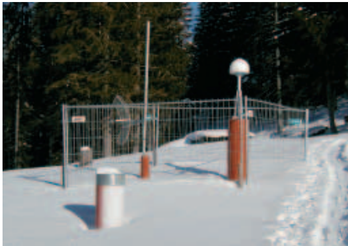
(En haut): station GPS permanente avec antenne LAN sans fil après l'achèvement.
