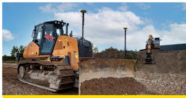
ブルドーザー用の Leica iCON iGD3 ソリューションは、移動する必要がある量の土のみを、すばやく確実に移動します。
