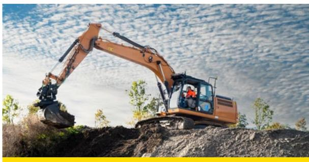
Leica iCON iXE3 マシンコントロールソリューションは、リアルタイムに切土/盛土を表示し、設計面と比較しながら効率よく掘削作業ができます。
