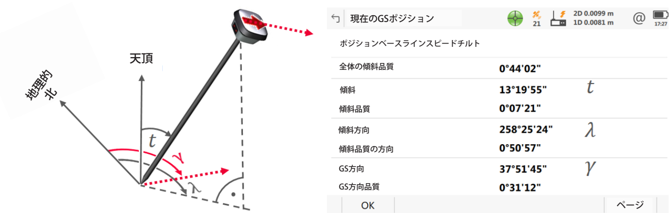
図8 - 傾斜 t 、傾斜方向 \lambda 、およびセンサー方位 \gamma を使用した、ライカGS18 Tのポールの傾きの解釈
