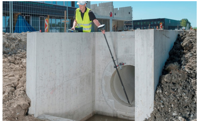
図3- ライカGS18 Tを使用して、従来の垂直ポールによるRTK測量では測定できなかった建物の隅や障害物のある点を測定する
