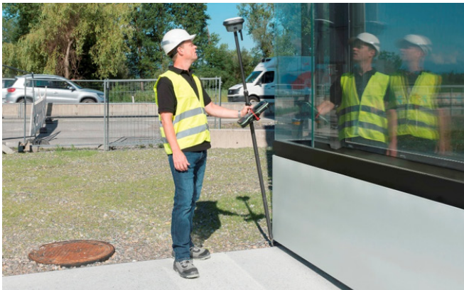
図3- ライカGS18 Tを使用して、従来の垂直ポールによるRTK測量では測定できなかった建物の隅や障害物のある点を測定する
