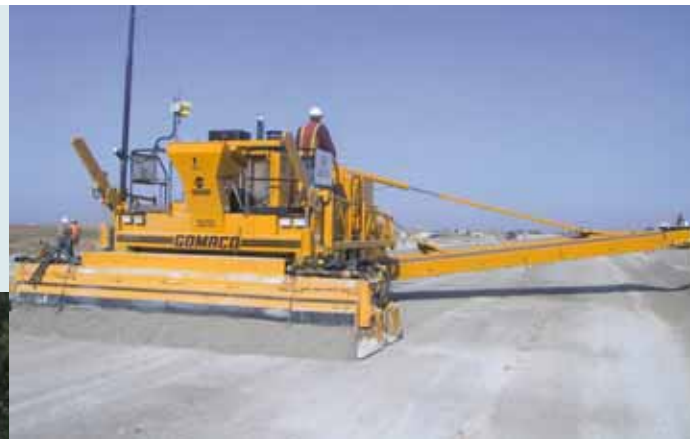
Une fraise de fin réglage Gomaco 9500 pilotée par le système Leica LMG-S 3D
