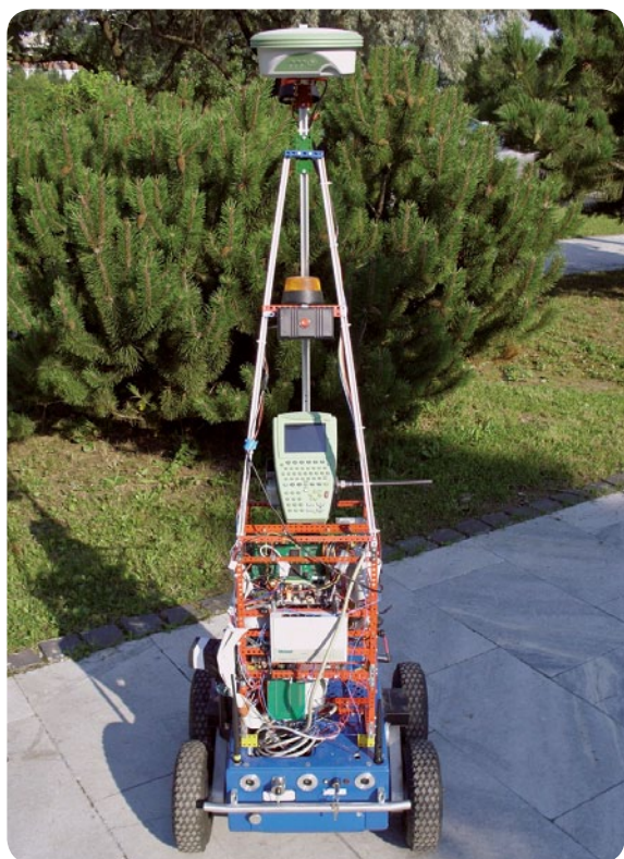
■ Наружный мобильный робот с приемником Leica GPS1200.
