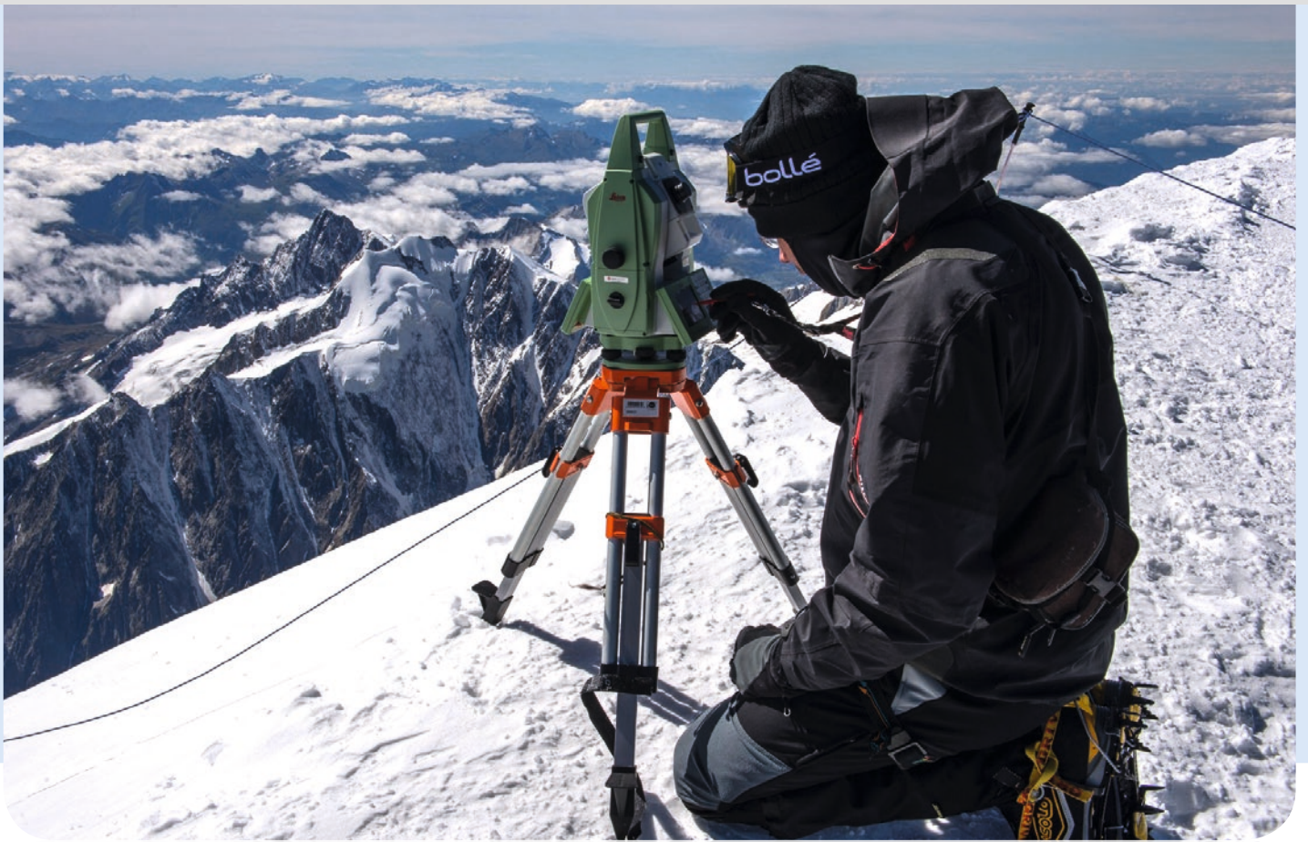
■ Подготовка Leica Nova MS50 MultiStation к 3D сканированию.
