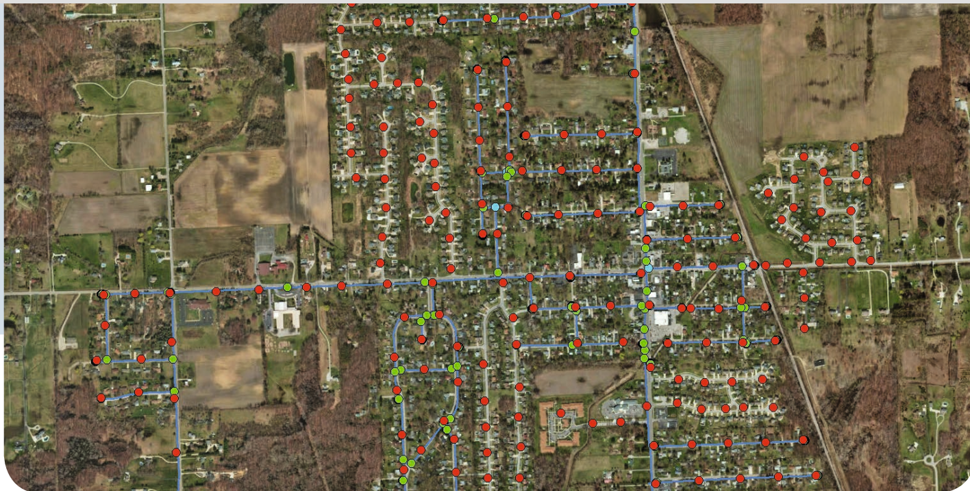
■ Водопроводы, пожарные гидранты и краны системы водоснабжения, обнаруженные Pegasus One.
