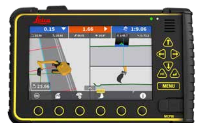
Kääntöpuomilla varustetun kaivukoneen näyttöruutu
