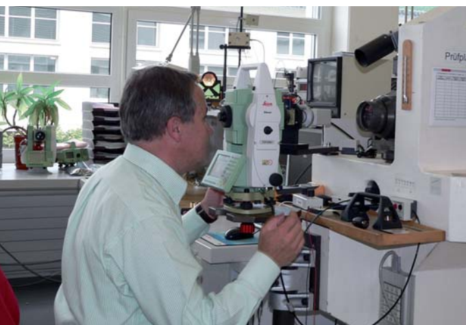
■ Guido Grossmann, membre de l'équipe CTS, règle une station totale Leica TCP1205+.
