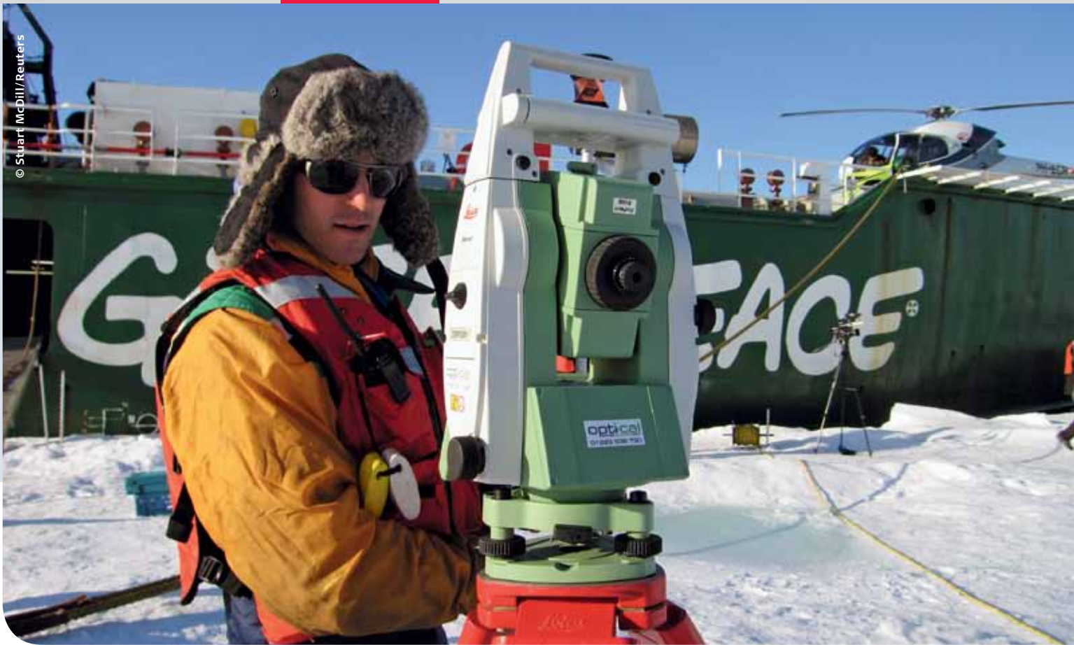
■ Nick Toberg, ante el «Arctic Sunrise», prepara la estación total Leica TPS1200+ para las mediciones.
