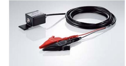
GEV71, Cable de alimentación Cable de alimentación de 12 V, 4 m de longitud. Protege al instrumento de los daños provocados por polaridad incorrecta y picos de tensión. Artículo: 439038
