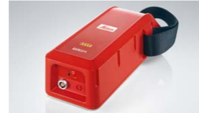
GEB373, Batería Li-ion externa Potente batería para estacionamientos de larga duración, 14,4 V / 289 Wh. Requiere GEV242 para carga. Gracias al cable GEV277, la batería puede usarse como UPS (fuente de alimentación ininterrumpida). Peso 2,3 kg. Artículo: 905305
