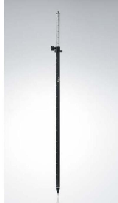
**GLS102, Ausziehbarer GNSS-Lotstab Reflektorstab aus Fiberkarbon/Aluminium mit Dreh- und Schnappverschluss gegen unabsichtliche Höhenverstellung. Zentimeter- und Fußteilung. Länge mind. 1,39 m, ausziehbar bis 2,3 m, Gewicht 1.290 g.**
