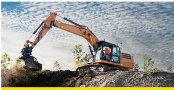
Die Maschinensteuerungslösung Leica iCON iXE3 liefert in Echtzeit Angaben für den Auf- oder Abtrag und ermöglicht es so, Baggerarbeiten nach einem Referenzentwurf schnell auszuführen.
