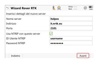
Spuntare Inserisci mountpoint manualmente e premere Avanti => digitare MAX3-RDN (NRT3-RDN se si utilizza l'abbonamento di tipo Nearest; IMAX3-RDN-MSM se si utilizza l'abbonamento di tipo FULL GNSS), premere INVIO e poi Avanti => spuntare Ricezione correzioni da rete RTK ed in Tipo Rete selezionare MAX (Nearest se si utilizza l'abbonamento di tipo Nearest; IMAX se si utilizza l'abbonamento di tipo FULL GNSS) => spuntare Invia messaggio GGA => non spuntare Invia ID Utente => premere Avanti
