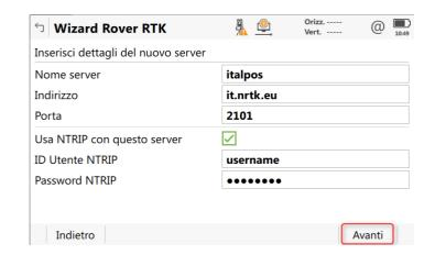
Spuntare Inserisci mountpoint manualmente e premere Avanti => digitare MAX3-RDN (NRT3-RDN se si utilizza l'abbonamento di tipo FULL GNSS), premere INVIO e poi Avanti => spuntare Ricezione correzioni da rete RTK ed in Tipo Rete selezionare MAX (Nearest se si utilizza l'abbonamento di tipo Nearest; IMAX se si utilizza l'abbonamento di tipo IMAX) => spuntare Invia messaggio GGA => non spuntare Invia ID Utente => premere Avanti
