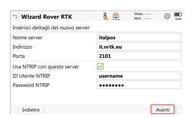
Spuntare Inserisci mountpoint manualmente e premere Avanti => digitare MAX3-RDN (NRT3-RDN se si utilizza l'abbonamento di tipo Nearest; IMAX3-RDN-MSM se si utilizza l'abbonamento FULL GNSS)), premere INVIO e poi Avanti => spuntare Ricezione correzioni da rete RTK ed in Tipo Rete selezionare MAX (Nearest se si utilizza l'abbonamento di tipo Nearest; IMAX se si utilizza l'abbonamento di tipo FULL GNSS) => spuntare Invia messaggio GGA => non spuntare Invia ID Utente => premere Avanti
