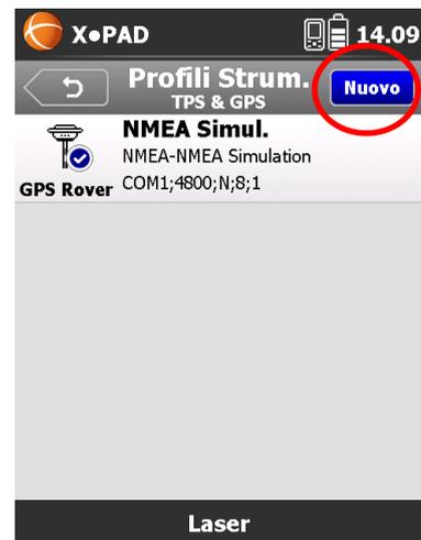
2. Definire il **NOME**, **MODALITA'**, **MARCA** e **MODELLO**; impostare collegamento **BLUETOOTH** e ricercare il dispositivo. Trovato il dispositivo selezionarlo e premere la freccia indietro per aggiungerlo alla lista dei dispositivi.
